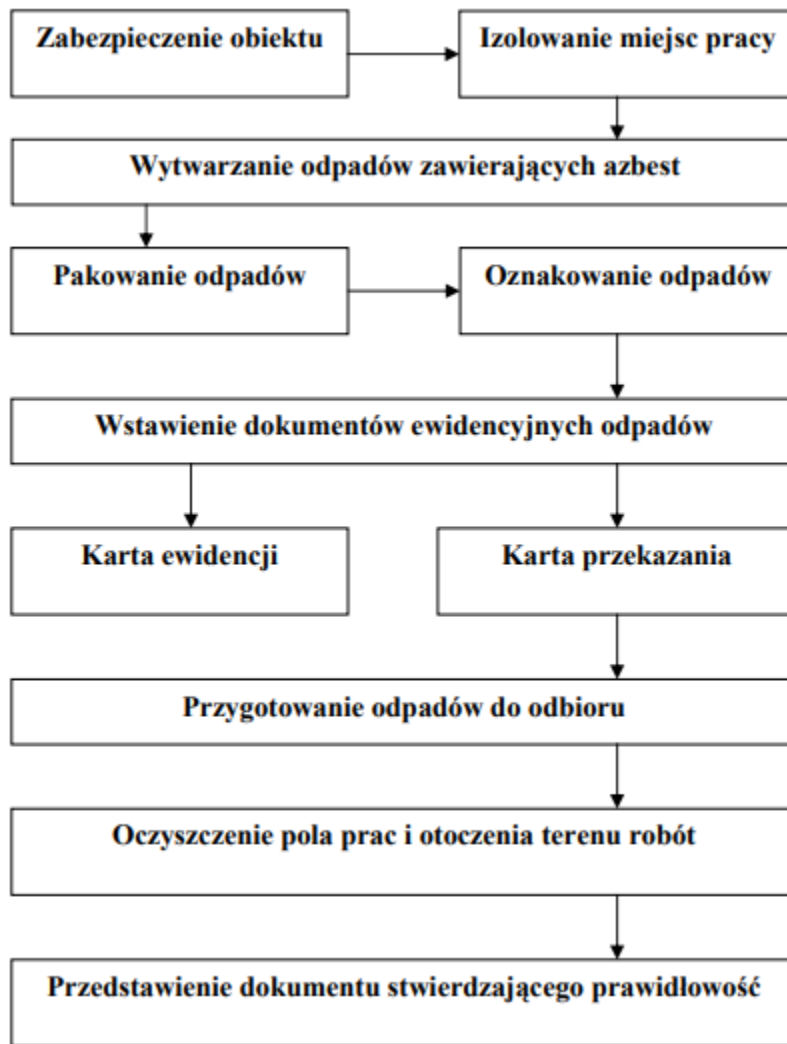
Rysunek 9. Prace polegające na usuwaniu wyrobów zawierających azbest, wytwarzaniu odpadów niebezpiecznych, wraz z oczyszczeniem obiektu, terenu, instalacji (źródło: Poradnik dla użytkowników wyrobów azbestowych)
